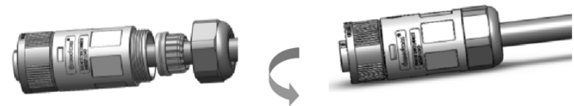
Figura 4.17 Apretar la tapa en el terminal
