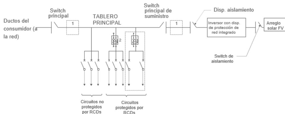
▲ Figura 4.21 Guía para una instalación simple de un inversor en un sistema de energía solar
