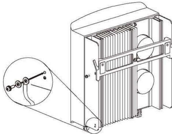
▲ Figura 4.19 Conecte el conductor externo a tierra
