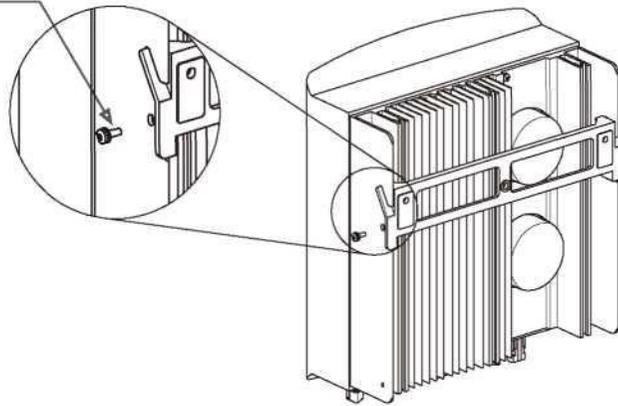
▲ Figura 4.5 Soporte para montar en la pared
