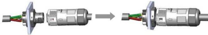
▲ Figura 4.1 8 Conecte los conectores de cc al inversor
