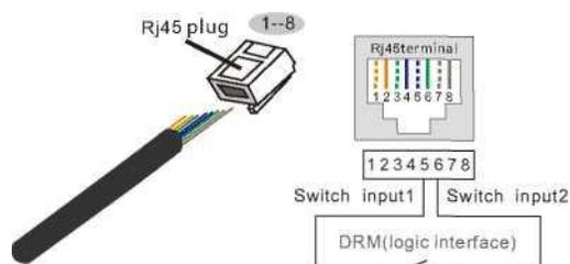
**La correspondencia entre los cables y los pines del enchufe, pin 5 y pin 6 de la terminal RJ45 se utiliza para la interfaz lógica, los otros pines están reservados.**
