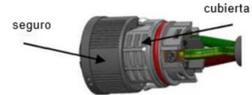
▲ Figura 4.16 Conecte los cables a la terminal
