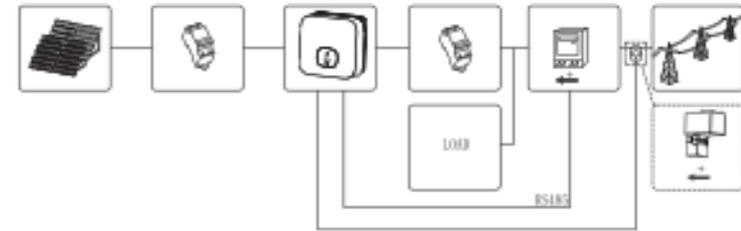
Control de energía activa con control de receptor de ondulación
