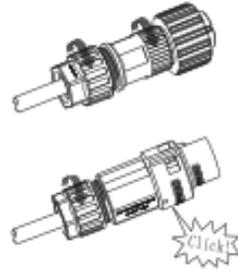
4. Finalmente, empuje o atornille la conexión roscada para conectar la terminal hasta que ambos estén ajustados firmemente en el inversor.
