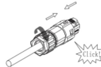
**Paso 3** Empuje la conexión roscada a la terminal de conexión hasta que ambos este asegurados firmemente en el inversor.
