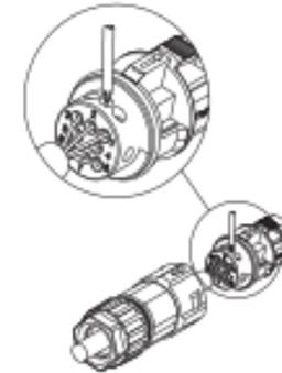
**Paso 2** Empuje la conexión roscada en el socket. Apriete la tapa en la terminal
