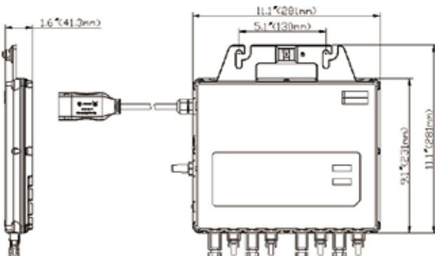
El QS1 micro inversor APsystems es de interconexion a la red electrica con inteligente con redes inteligentes y sistemas avanzados de monitoreo para asegurar la máxima eficiencia. Alta eficiencia, alta confiabilidad del QS1 con 4 entradas MPPT independientes, potencia máxima de salida de CA que llega a 1200W. El trimestre de los inversores y el trimestre de la instalación significan ahorros de costos reales para clientes residenciales y comerciales.
