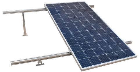
Estructura de montaje ajustable, diseñada para su fácil instalación, adaptable a las diferentes necesidades del sistema fotovoltaico con una garantía de 20 años. Está fabricada con materiales de alta calidad otorgando un plus en durabilidad y funcionalidad; extruido en aluminio 6005-T5 con un anodizado de 5 micras, beneficio que le permite instalarse en climas tropicales.
